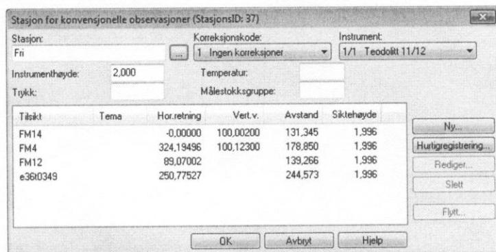
3.1 Kva for punkt trur du det er feilmåling til ut i frå avviksdokumentasjon etter berekning. Grunngjev og dokumenter svaret med skjermdump.
